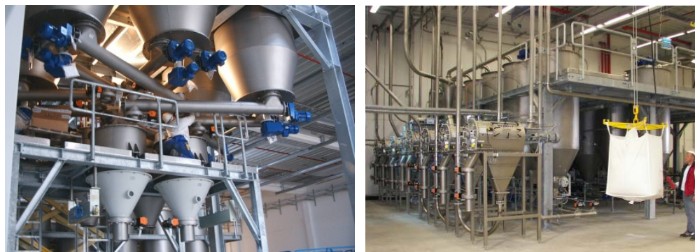
Reimelt Verwiegestation und Rotations-Siebmaschinen
