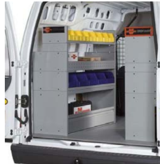
LCV (leichtes Nutzfahrzeug) mit Fahrzeugeinrichtung VANyCARE®-Transporter Boden Pro
